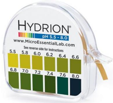
Este rollo de papel para medir pH provee una separación de colores tanto en el rango ácido (bajo pH 7) y el rango alcalino (sobre pH 7). Ofrece una manera fácil de leer el color similar para intervalos de cada .2 a .3, desde pH 5.5 a 8.0.
