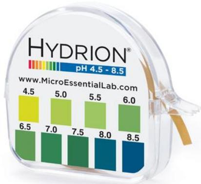
Este rollo de papel para medir pH provee una separación de colores tanto en el rango ácido (bajo pH 7) y el rango alcalino (sobre pH 7). Ofrece una manera fácil de leer el color similar para intervalos de cada .5, desde pH 4.5 a 8.5.
